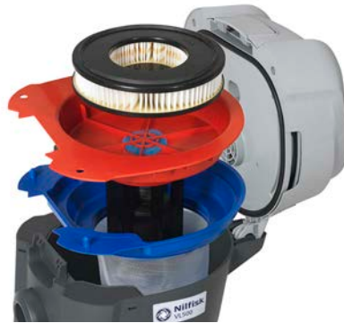
Kaksoisuodatusjärjestelmän ansiosta voidaan imuroida kuivaa tai märkää kohteen mukaan ilman suodattimen vaihtoa kohteen vaihtuessa
